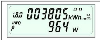
Spannungsausfall einer Phase
